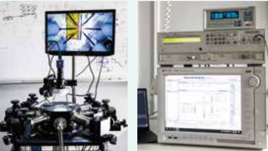
Cryo CMOSトランジスタのモデル開発に用いている極低温ブローバーと測定器
